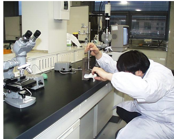
軽く押さえつけ、試料面を水平にする。 力を入れすぎるとガラスが割れるので注意！
