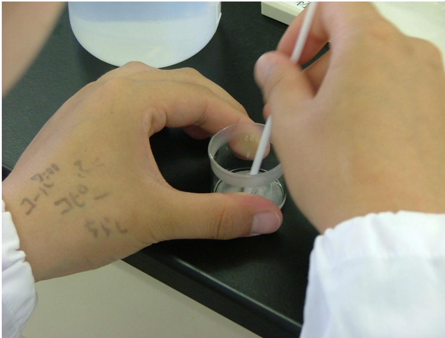
シュウ酸ナトリウムはすぐには溶けない。また、秤量瓶で全て溶解させるのも無理。写真のように、プラスチック製の混ぜ棒で、塊をつつくように潰して溶かす。ある程度溶けたら、流し出すようにしてメスフラスコに全部入れる。
