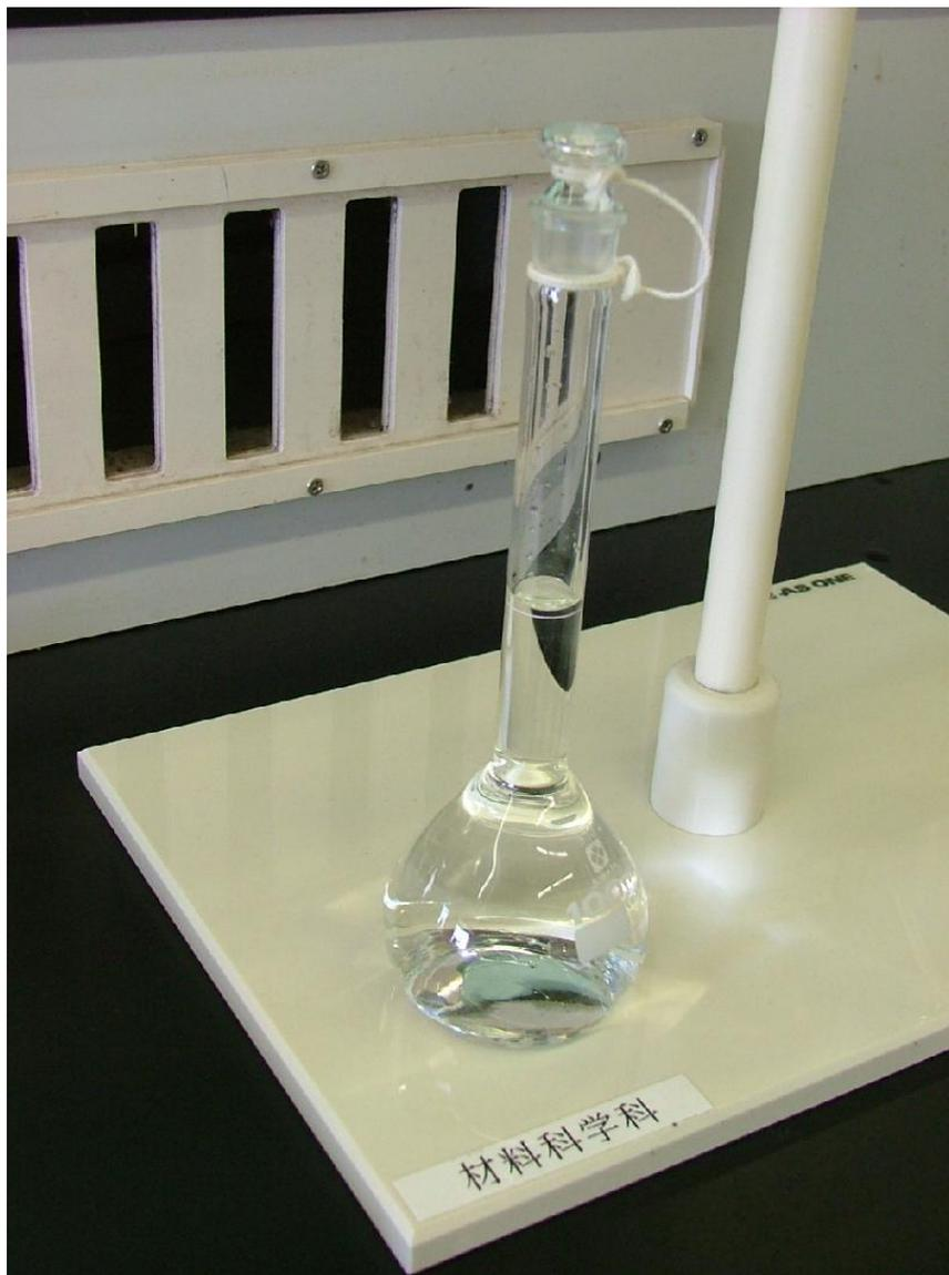
完全に溶けたら、蒸留水を追加してメニスカスに合わせる。
